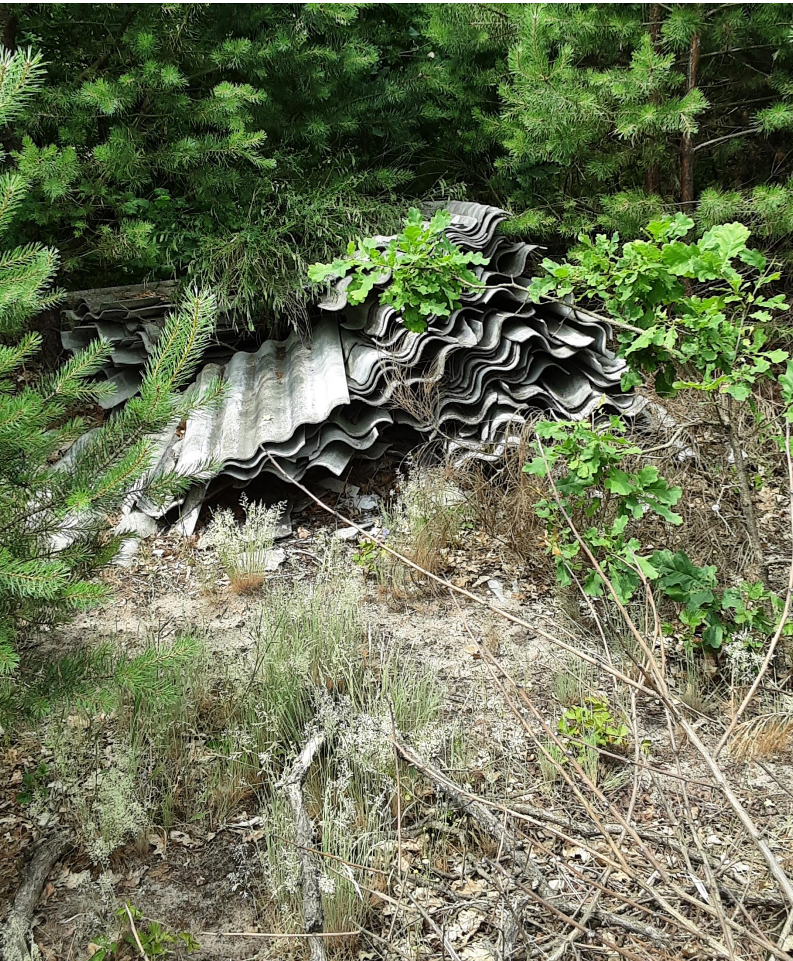
Fot. 2. Nielegalne składowanie wyrobów azbestowych.
